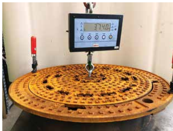
Auszugtest an einer fabrikneuen Schachtabdeckung
